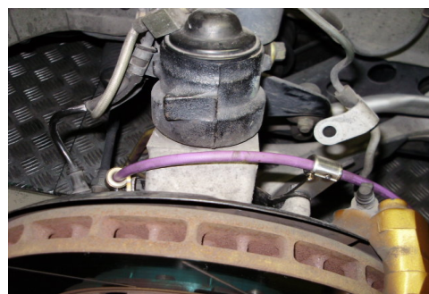
ボディーからキャリパー迄を一本のホースで取り付けするGTR用フロントスペシャルブレーキライン
