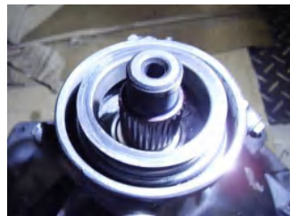
ハウジング部の摩耗によるがたつき
